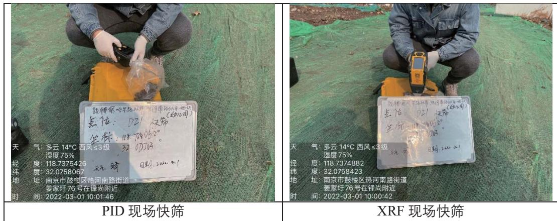
图 2-10 PID 和 XRF 现场标定及检测照片
